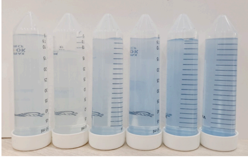
चित्र 4.12 विभिन्न सांद्रताओं पर सिलिकेट मानक विलयनों की स्पेक्ट्रोफोटोमेट्रिक विश्लेषण हेतु तैयारी
