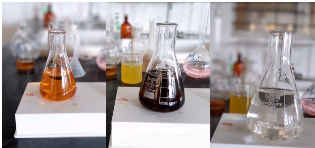
चित्र 3.7 टाइट्रेशन के दौरान क्रमिक रंग परिवर्तन
