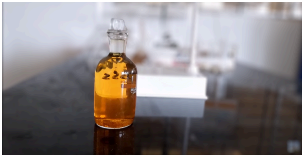
चित्र 3.6 सान्द्र सल्फ्यूरिक अम्ल (Conc. Sulfuric Acid) मिलाने के बाद जल नमूने में अवक्षेप (Precipitate) का निर्माण
