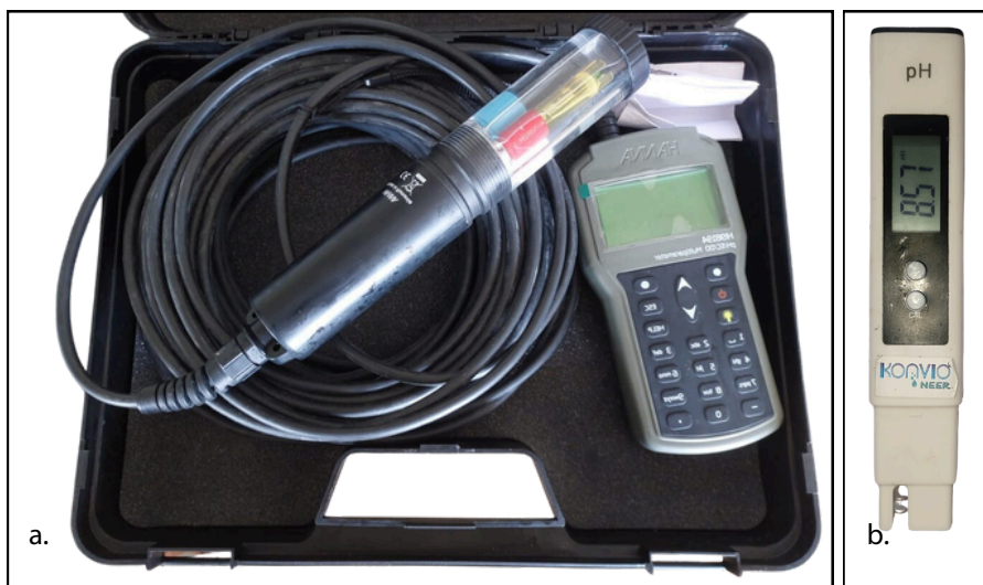
चित्र 3.2 (a) pH आकलन हेतु बहु-परिमापी परीक्षण किट, (b) pH जांच-सूचक यंत्र
