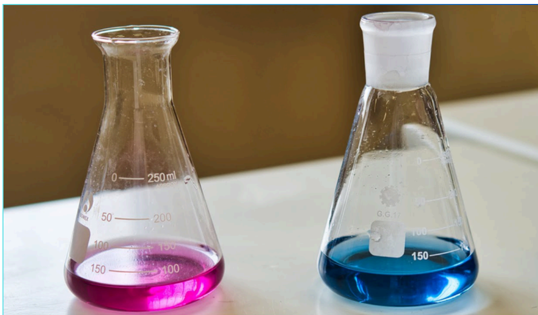
चित्र . 5.1 कठोरता विश्लेषण हेतु टाइट्रेशन के दौरान रंग में क्रमिक परिवर्तन
