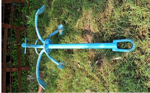
चित्र 2 : निर्माण एवं संयोजन में उपयोग करने वाला पिंजरा एवं लंगर प्रणाली के संरचनात्मक घटक
